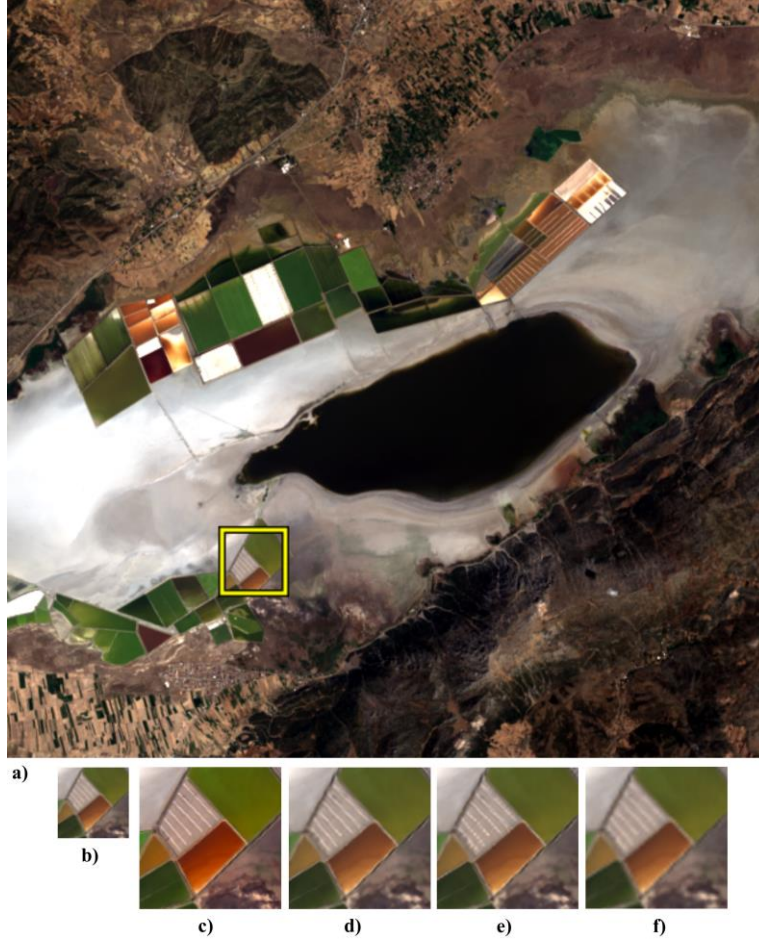
Şekil-2: a) 600x600 Landsat-8 OLI/TIRS orijinal görüntü, b) 50x50 piksel boyutlu Landsat-8 OLI/TIRS orijinal görüntü, c) 100x100 piksel boyutlu pan-keskinleştirilmiş görüntü, d-f) 100x100 piksel boyutlu EDSR, DBPN ve Bikübik yöntemleriyle elde edilmiş süper-çözünürlüklü görüntü.
